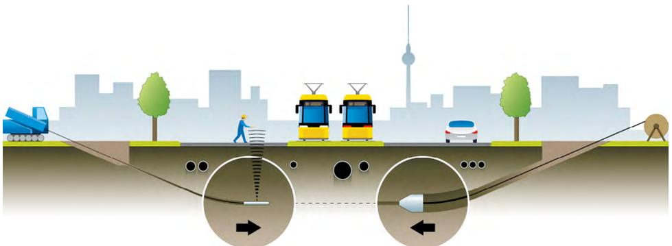
**Horizontalspülbohrung:** vereinfachte Darstellung einer Horizontalspülbohrung unter einer Straßenbahntrasse
