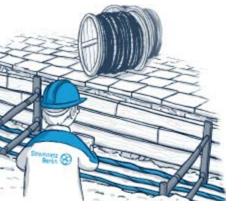
Für die Instandhaltung und den Ausbau des Stromnetzes sind umfangreiche **Tiefbaumaßnahmen** notwendig. Der **Großteil der Kabel verläuft unterhalb von Fußwegen**.
