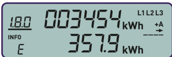
Mit einem langen Anleuchten (> 5 Sek.) löschen Sie die gespeicherten Energiewerte und in der zweiten Displayzeile sehen Sie:
