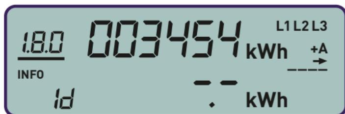
Die Löschung der historischen Energiewerte können Sie auch bei den Anzeigen 7d, 30d, 365d und 730d in gleicher Weise durchführen.
