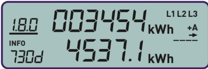
Sind bei der modernen Messeinrichtung mehrere Zählwerke aktiv, so werden Ihnen die historischen Energiewerte für jedes Zählwerk angezeigt. Für die Zuordnung der historischen Werte wird in der ersten Displayanzeige das gerade relevante Zählwerk (siehe Ziffer 2 auf Seite 8) und der Gesamtverbrauch dieses Zählwerks angezeigt.
