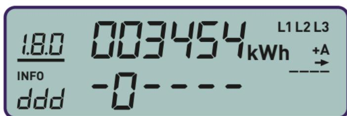
Für die Eingabe der Tageszahl leuchten Sie mehrfach kurz (< 4 Sek.) mit der Taschenlampe auf die optische Taste, bis in der zweiten Displayzeile „ddd“ blinkt und an der zweiten Stelle die Ziffer 0 steht.
