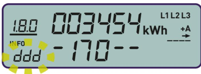
Leuchten Sie die optische Taste mehrfach kurz (< 4 Sek.) an, bis die dritte Ziffer der von Ihnen gewünschten Tageszahl an der vierten Stelle angezeigt wird.
