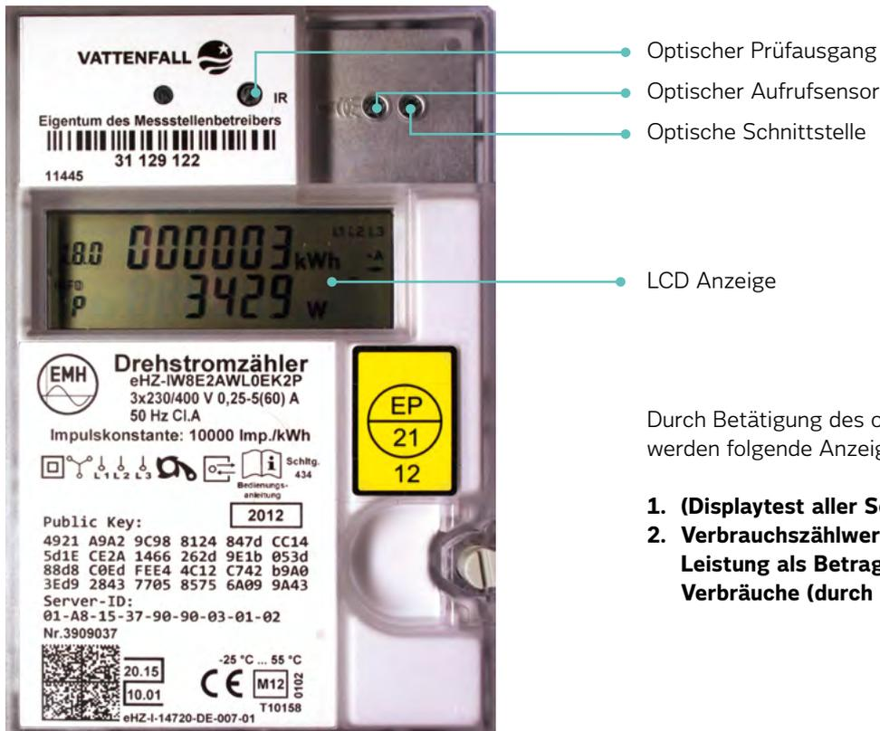
Durch Betätigung des optischen Aufrufsensors werden folgende Anzeigeninhalte sichtbar:
