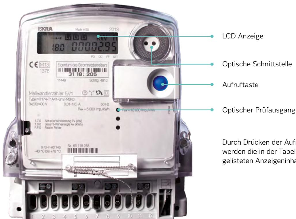
Durch Drücken der Aufruftaste werden die in der Tabelle unten aufgelisteten Anzeigeninhalte sichtbar.
